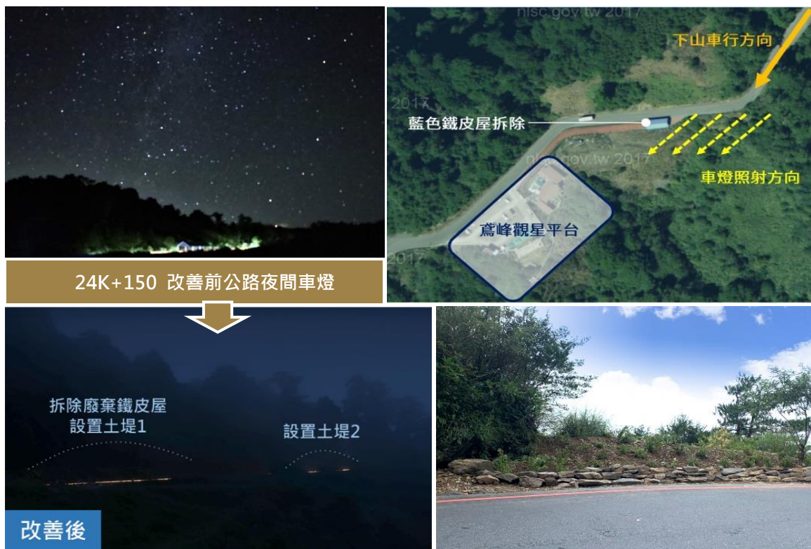
圖 10 協調改善設置土堤，降低車流光害，以人為本的和諧公路。
