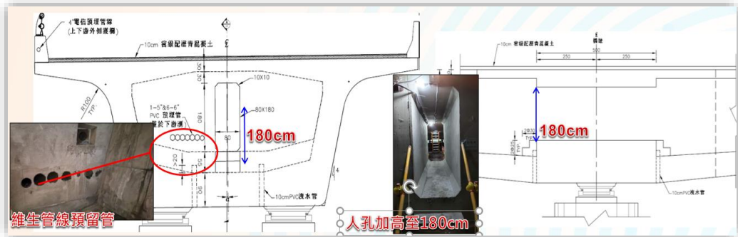
圖 23 檢修人孔與維生管線附掛設計
