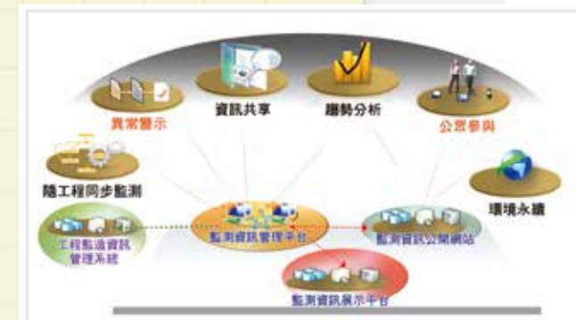
● 監測資訊系統平台功能架構
