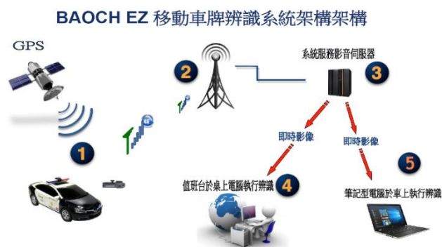
圖 3-1 移動式車牌辨識系統架構原理
