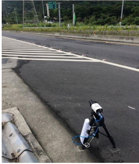
圖 3-2 本站購置之移動式車牌辨識系統於道路上使用
