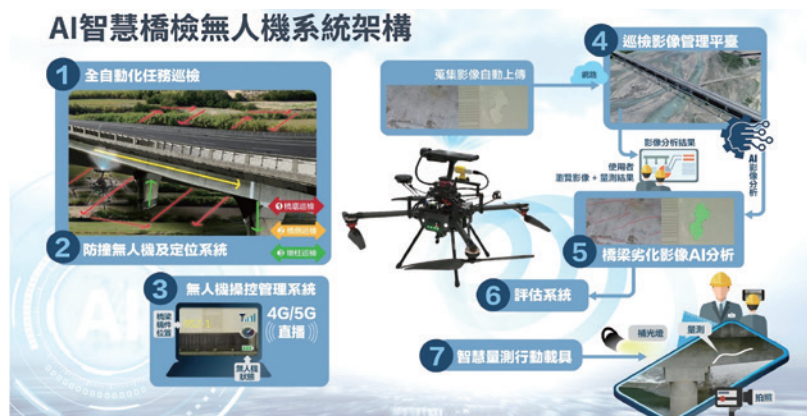
AI 智慧橋檢無人機系統架構
