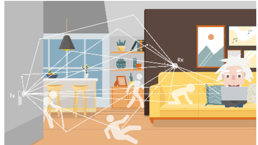
在充滿Wi-Fi訊號的空間中，每個成員的移動都會影響訊號波的狀態。 Tx (transmit) 代表發送數據，Rx (receive) 代表接收數據。 資料來源：Origin Wireless, Inc. (謝宏昀教授提供)
