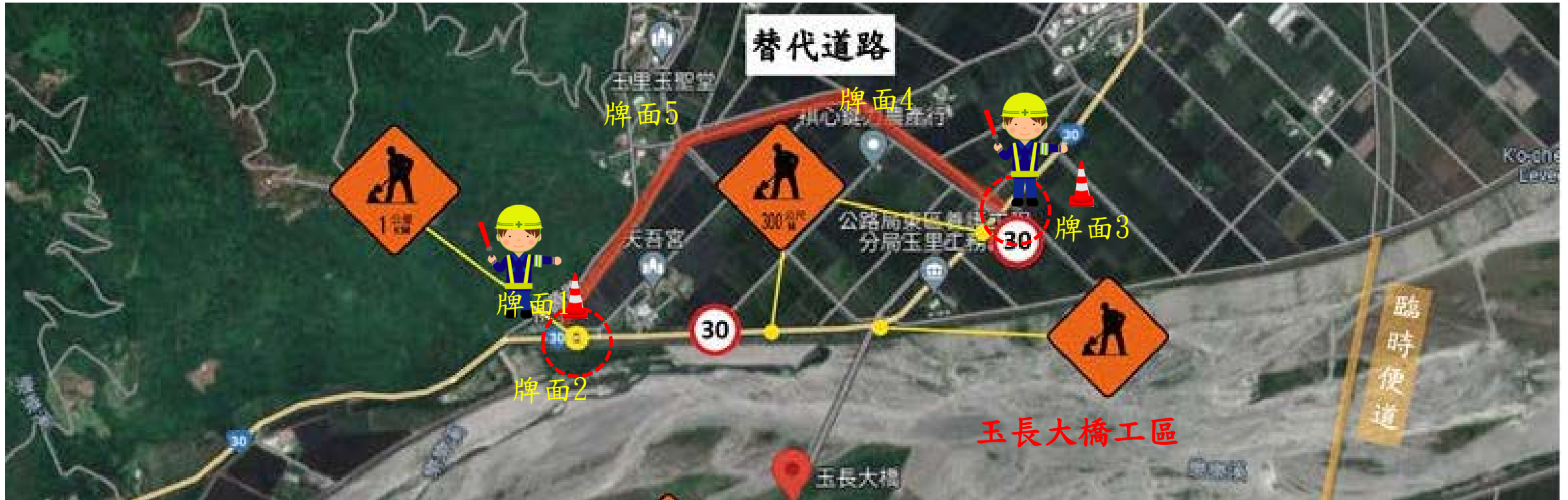
玉長大橋橋面版施工托架及底模拆除(墩柱編號P1~橋台編號A1) 省道台30線交通管制及替代道路平面示意圖
