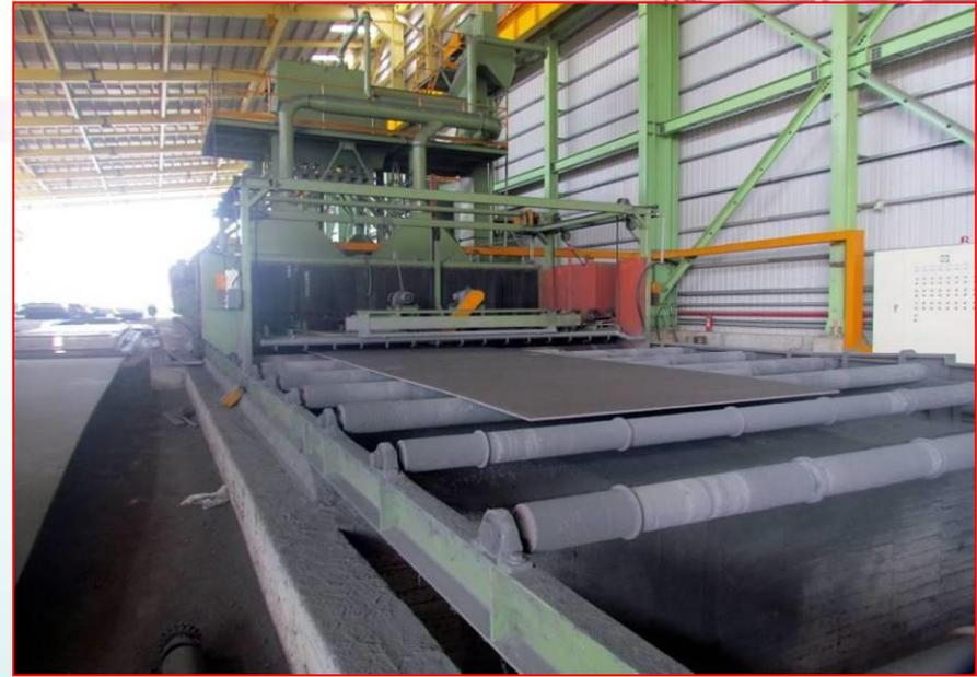
隧道式自動噴砂機(鋼板噴砂)
