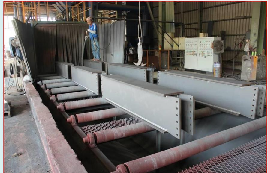
隧道式自動噴砂機(型鋼噴砂)
