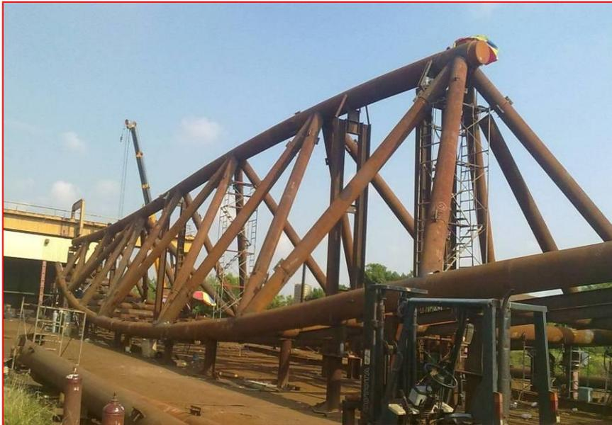
管桁架結構
