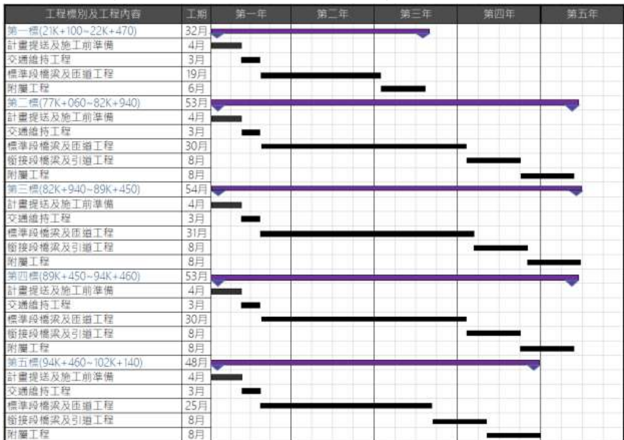
圖 4.2-3 各標預計施工工期排程圖
