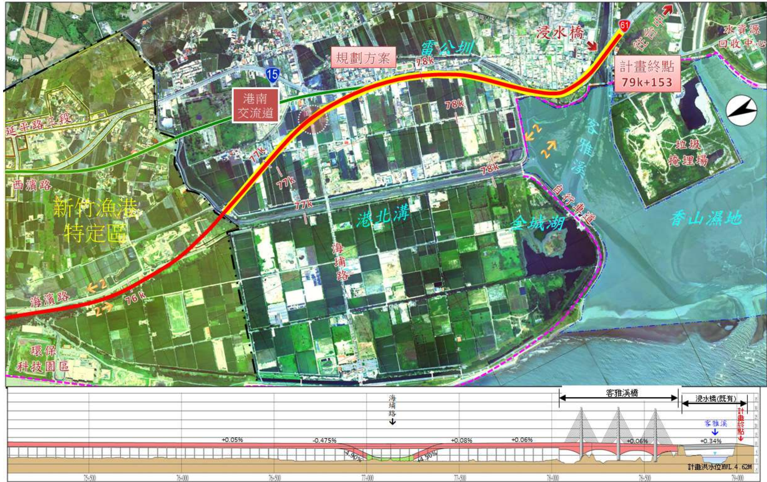
圖 3.3-40 計畫範圍竹苗路段北側銜接西濱快速公路鳳鼻至香山段方案路線平縱面圖
