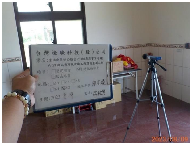
照片說明：低頻營建噪音 拍攝地點：2-2 監測時間：112.08.09
