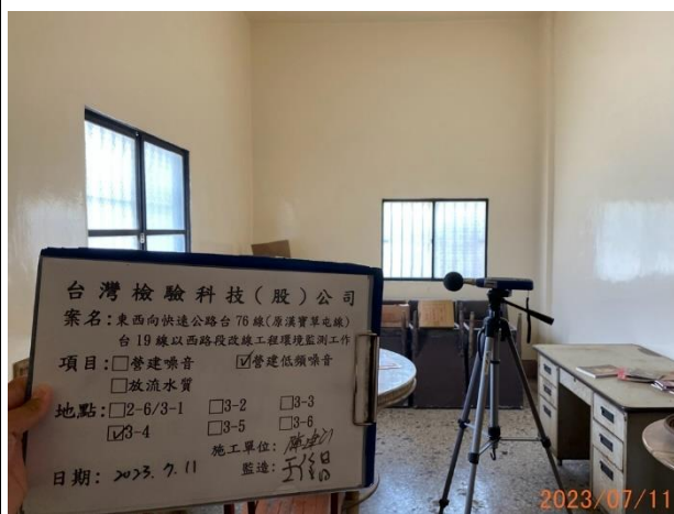
照片說明：低頻營建噪音 拍攝地點：3-4 監測時間：112.07.11
