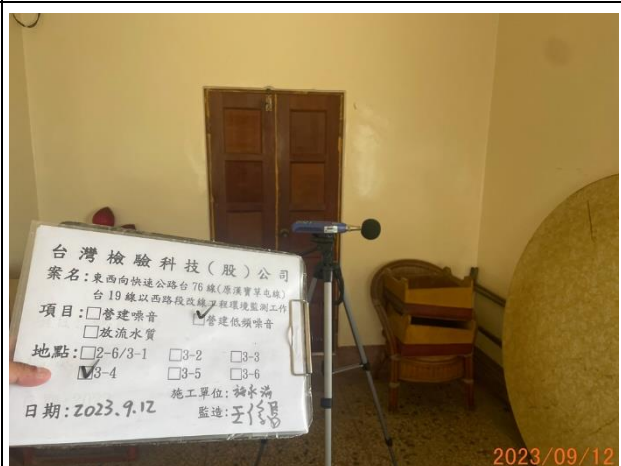
照片說明：低頻營建噪音 拍攝地點：3-4 監測時間：112.09.12
