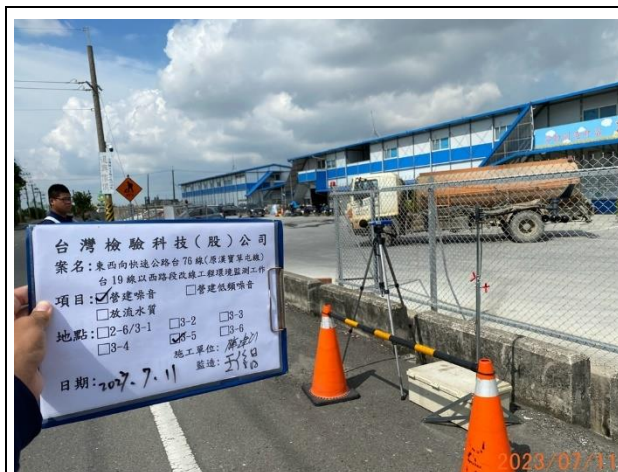
照片說明：營建噪音 拍攝地點：3-5 監測時間：112.07.11
