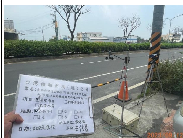
照片說明：營建噪音 拍攝地點：2-6/3-1 監測時間：112.09.12
