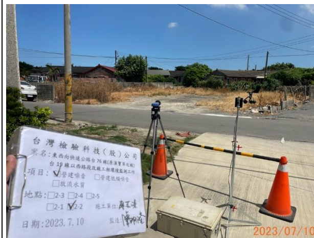
照片說明：營建噪音 拍攝地點：2-2 監測時間：112.07.10
