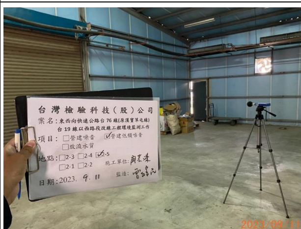
照片說明：低頻營建噪音 拍攝地點：2-5 監測時間：112.09.11
