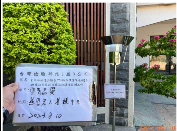
照片說明：空氣品質(落塵) 拍攝地點：慈恩養護中心 監測時間：112.08.10-09.10
