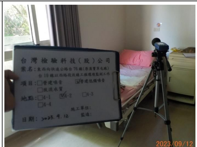
照片說明：低頻營建噪音 拍攝地點：4-2 監測時間：112.09.12
