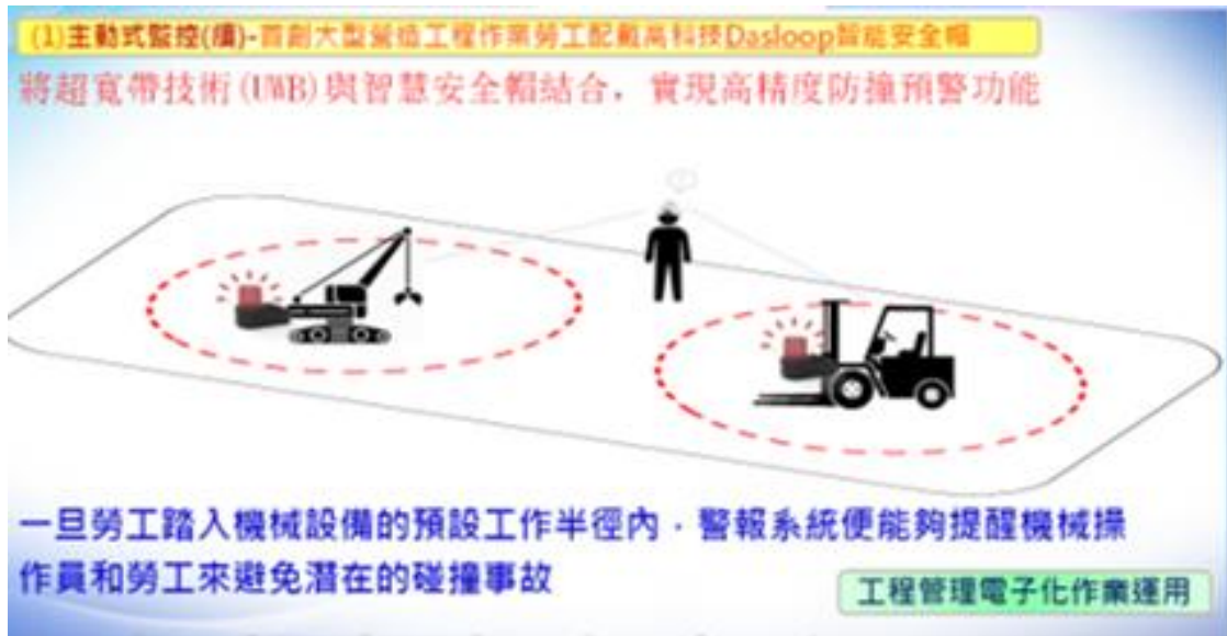
圖 1-8 物聯網 IOT 科技應用，主動式監控
