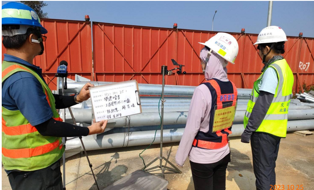
圖 9-21 工區噪音監測
