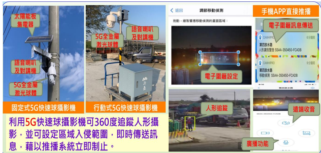
圖 1-10 主動式監控-5G 快速球攝影機電子圍籬及推播系統
