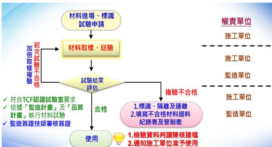
圖 8-23 材料設備進場抽(試)驗流程
