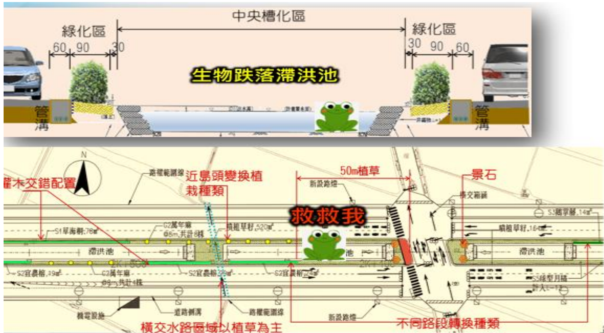
圖 9-25 中央槽化滯洪池空間設置入滲池
