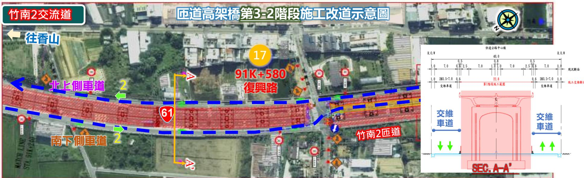
調整施工順序利用門架式橋墩下空間做為施工期間車輛改道通行車道:
