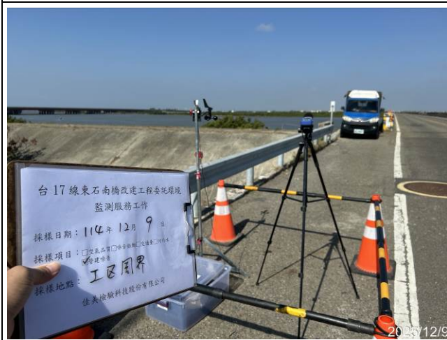
營建噪音(工區周界)-12月
