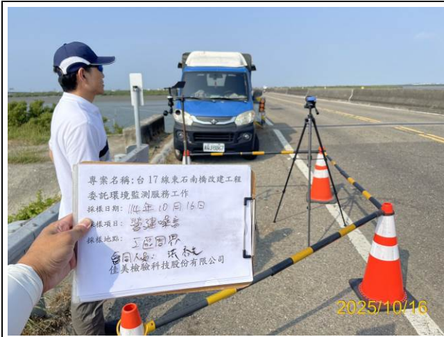
營建噪音(工區周界)-10月
