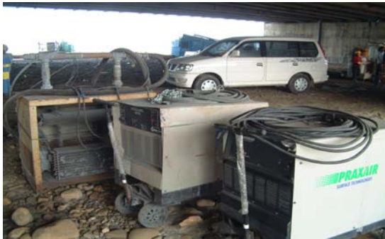
照片 9-9 鋅鋁熔射相關機組
