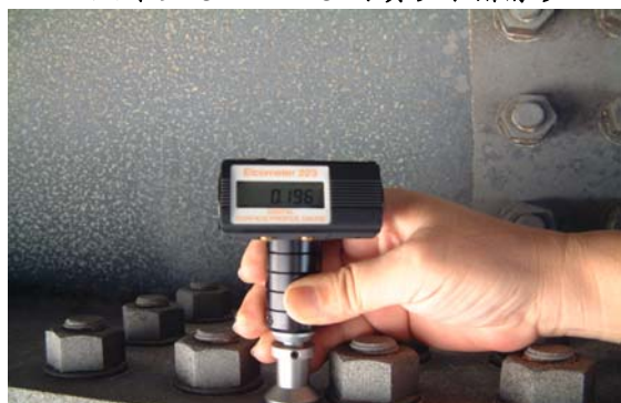
照片 9-15 噴砂除鏽後粗度計檢測( >60\mu\text{m} )
