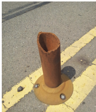
圖二十六 交通桿受撞擊後斷裂之例
