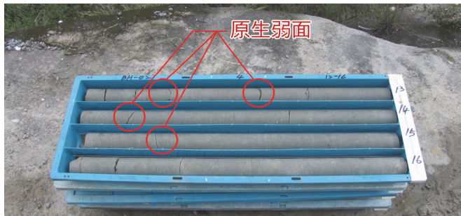
圖 5-5 鑽孔 BH02 岩心沿沉積弱面斷裂
