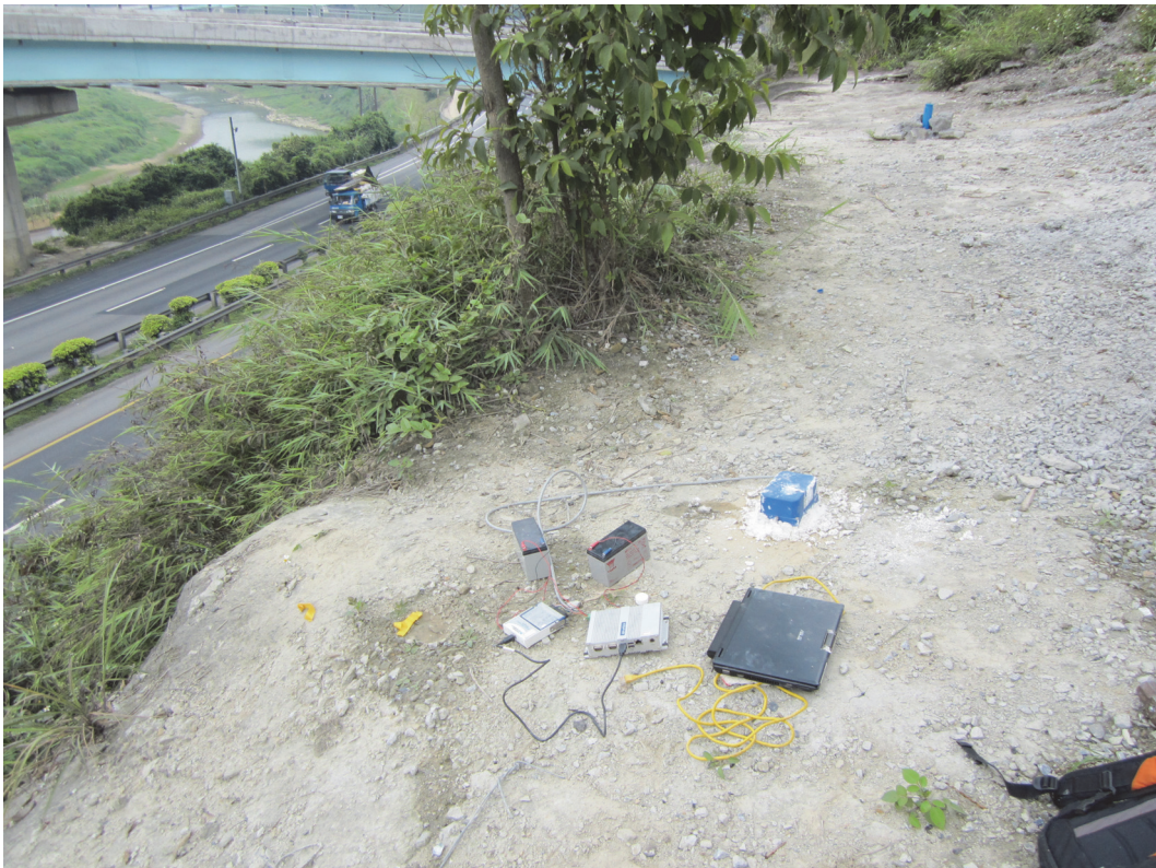
圖 4-3 量測坡頂微震動速度及加速度
