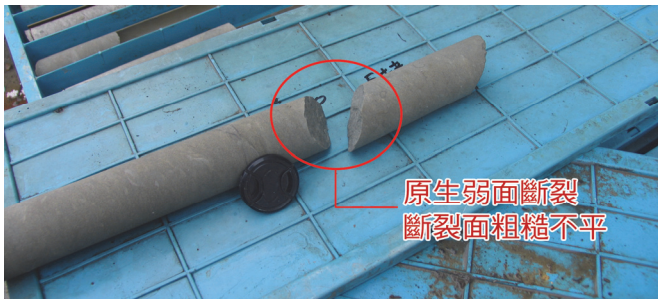
圖 5-6 原生弱面斷裂面粗糙不平
