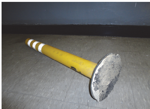
圖三十 黏結式交通桿受撞擊後脫離原位
