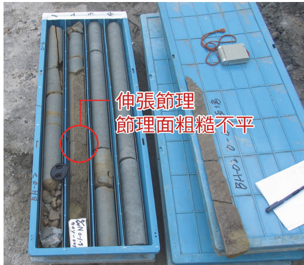
圖 5-7 鑽孔 BH-02 節理面粗糙不平
