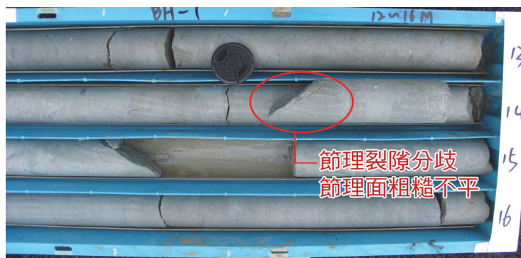
圖 5-4 BH02 孔深度 13.8m 處裂隙分歧
