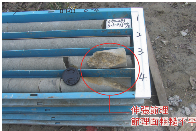
圖 5-8 鑽孔 BH-03 節理面粗糙不平
