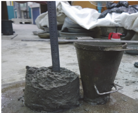
圖 8 量測混凝土坍度
