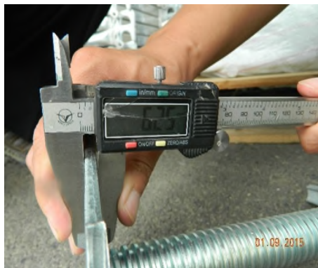
施工架調整座厚度檢查
