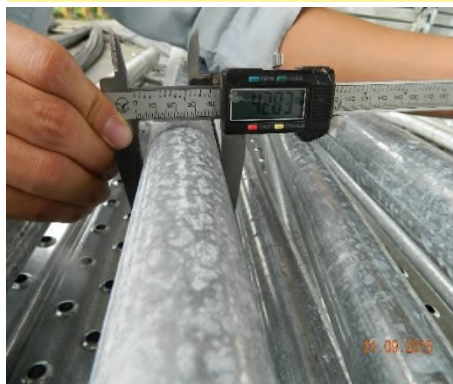
施工架鋼管管徑檢查
