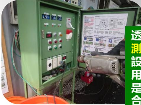
透過漏電檢測箱於電氣進場前先用合格電氣貼上合格標籤以利識別
