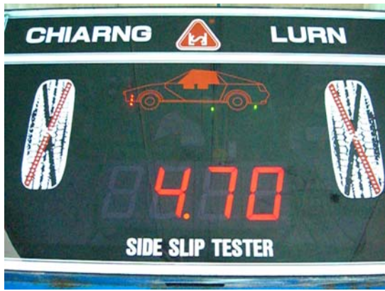
相片3-1-4 側滑測試器表頭新式-數位式2 (台製) 小數點0.01
