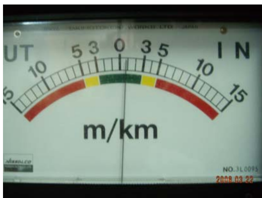
相片3-1-1 側滑測試器表頭-舊式 電子指針式(日製)每 1小格1公尺(小數點 0.5)
