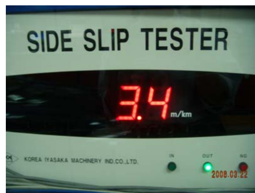
相片3-1-2 側滑測試器表頭-新式 數位式1(韓製)小數 點0.1
