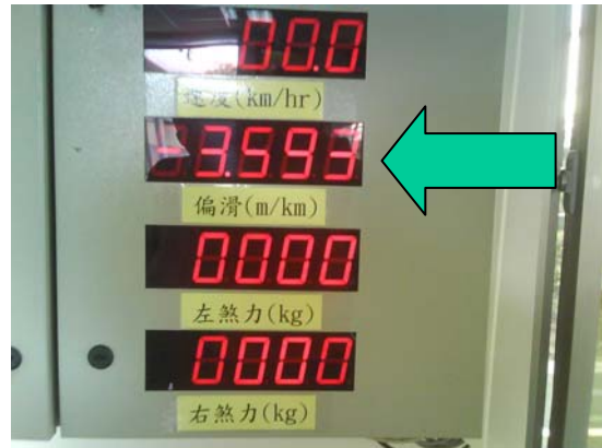
相片3-1-5 側滑測試器表頭-新式數位式3 (台製) 小數點0.001
