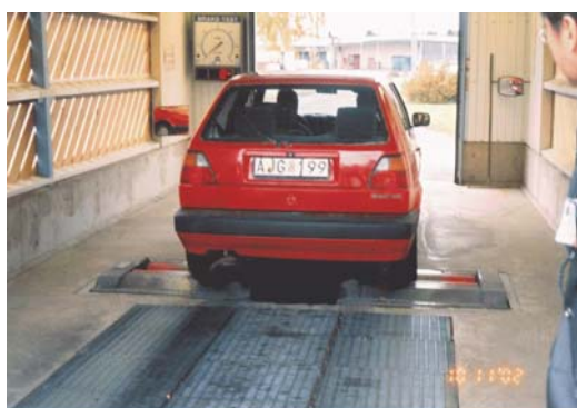
相片 2-2-1-3 瑞典車輛定期檢驗靜態煞車性能測試及各項底盤檢查
