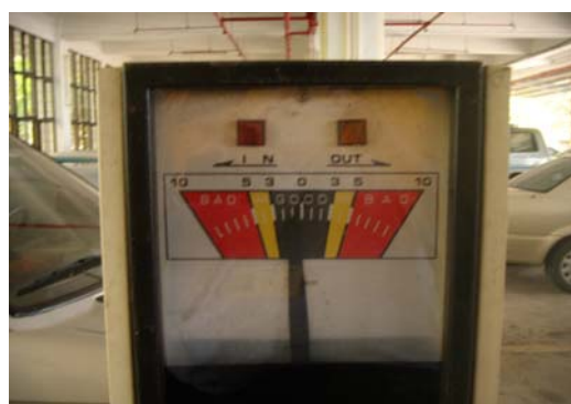
相片3-1-3 側滑測試器表頭-機械指 針式
