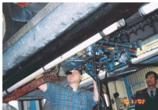
相片 2-2-1-3 瑞典車輛定期檢驗靜態煞車性能測試及各項底盤檢查
