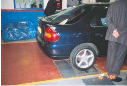
相片 2-2-1-2 英國汽車定期檢驗站靜態煞車性能測試及頭燈光度、位置檢驗
