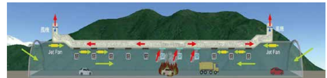
複合型點排式通風系統-緊急模式
