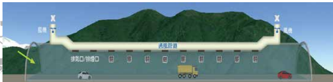
複合型點排式通風系統-正常模式
