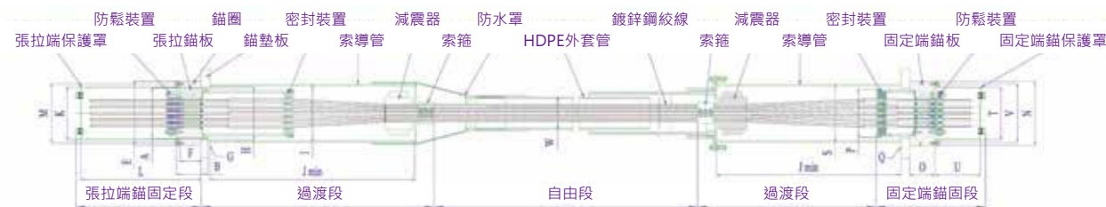
• 白米橋斜張系統構件圖
