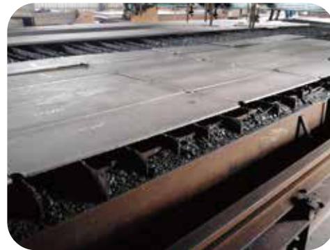
• 鋼板放樣切割
