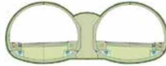
5. 完成管道、水溝、路面工程
