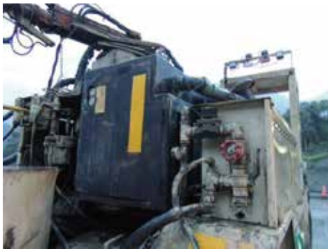
● 噴漿機附掛空壓設備
