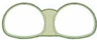
4. 主坑襯砌施作
