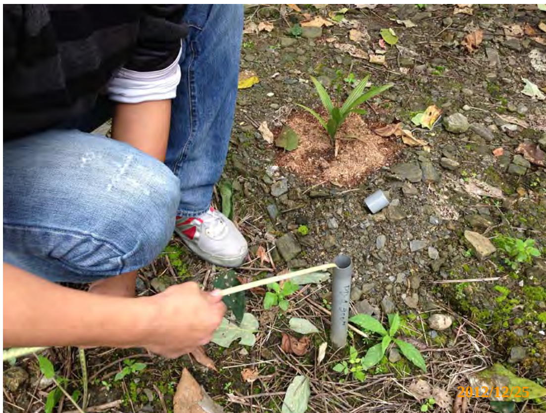
圖 3.5-5 PB-7 既有地下水位井現場量測作業情形
