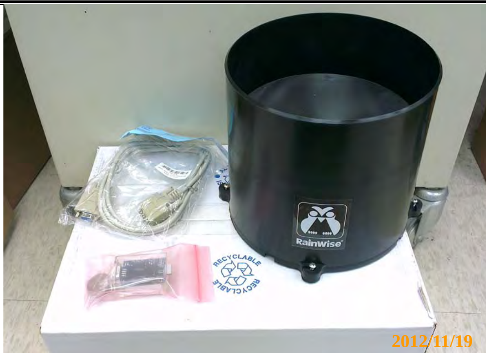
圖 3.2-2 自記式雨量計儀器照片
