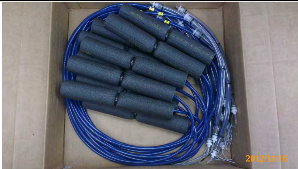
圖 3.5-9 電子式水位計儀器照片
