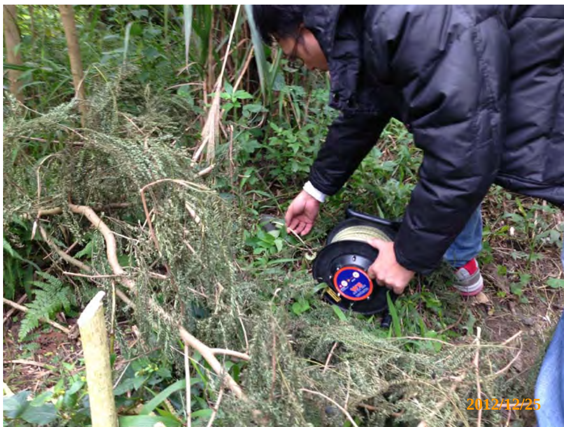
圖 3.5-4 PB-6 既有地下水位井現場量測作業情形
