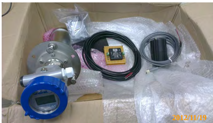
圖 3.4-4 自記式河川流量觀測儀器照片
