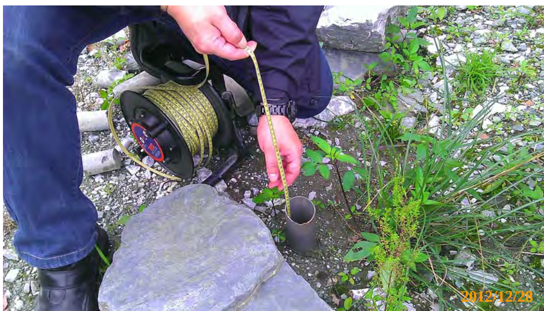
圖 3.5-6 BT-05-01 既有地下水位井現場量測作業情形
