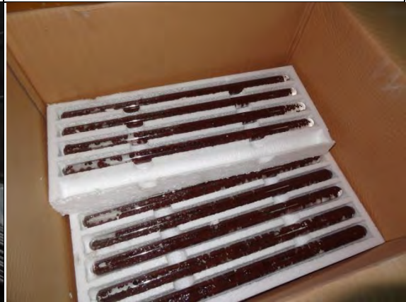
➤ C1 標南口：隧道北上線工料堆置區，玻璃急結管
