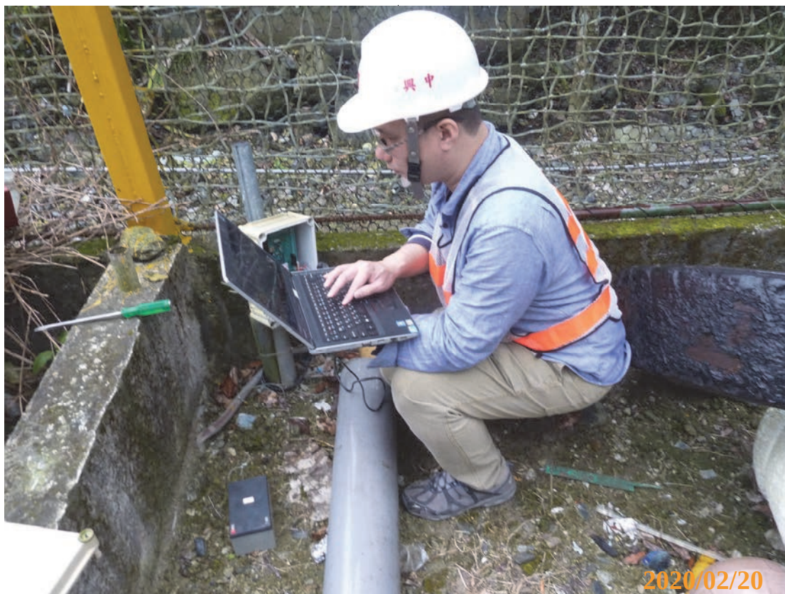
圖 4 自記式水位觀測井 BH-07 資料讀取下載情形
