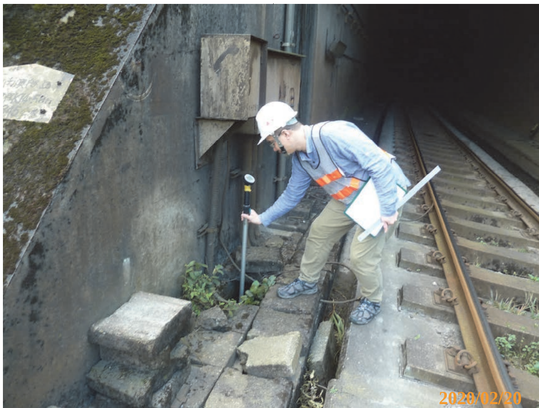
圖 2 新南澳鐵路隧道北口排水量觀測作業
