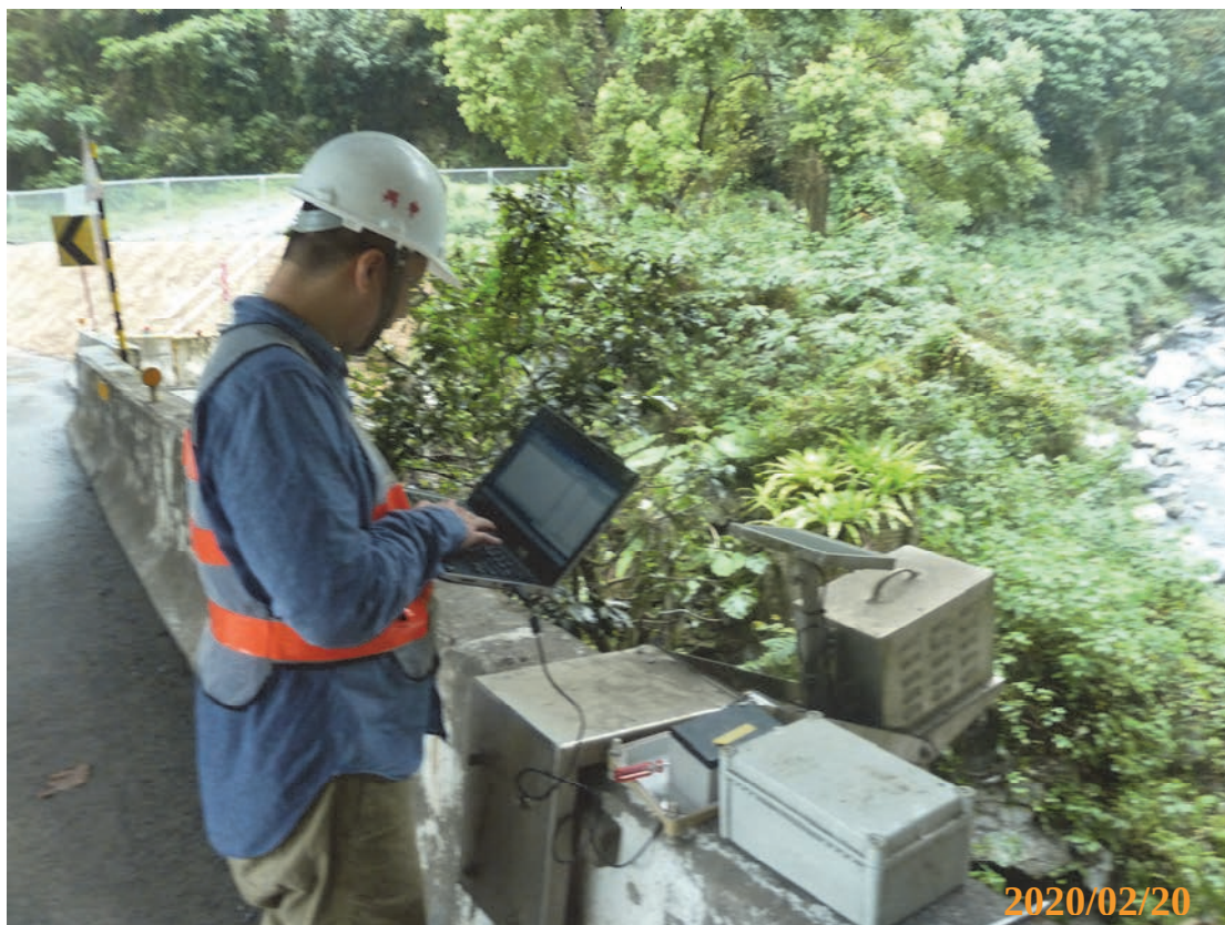
圖 3 清水溪之自記式流量站資料讀取下載情形
