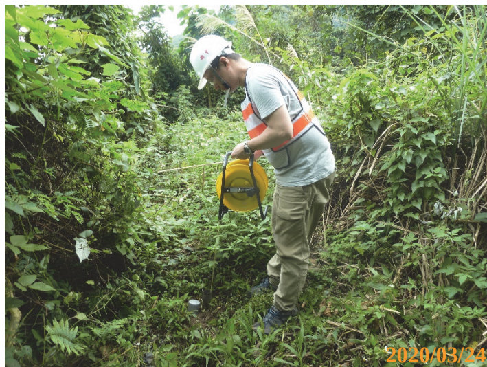
圖 3.5-3 PB-06 地下水位井現場量測作業情形
