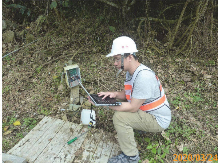
圖 3.5-1 BH-06 自記式水位觀測井資料下載作業情形
