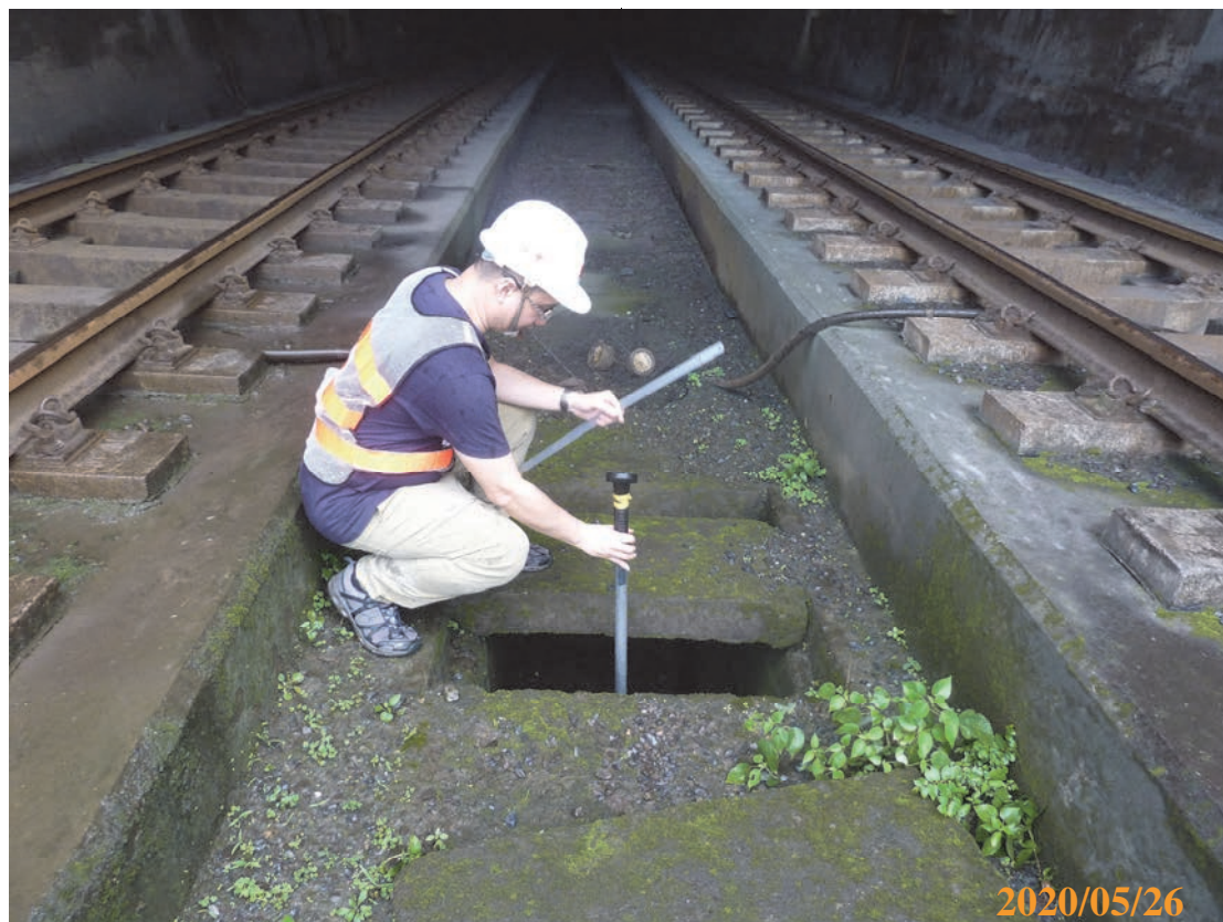
圖 2 新和平鐵路隧道北口排水量觀測作業
