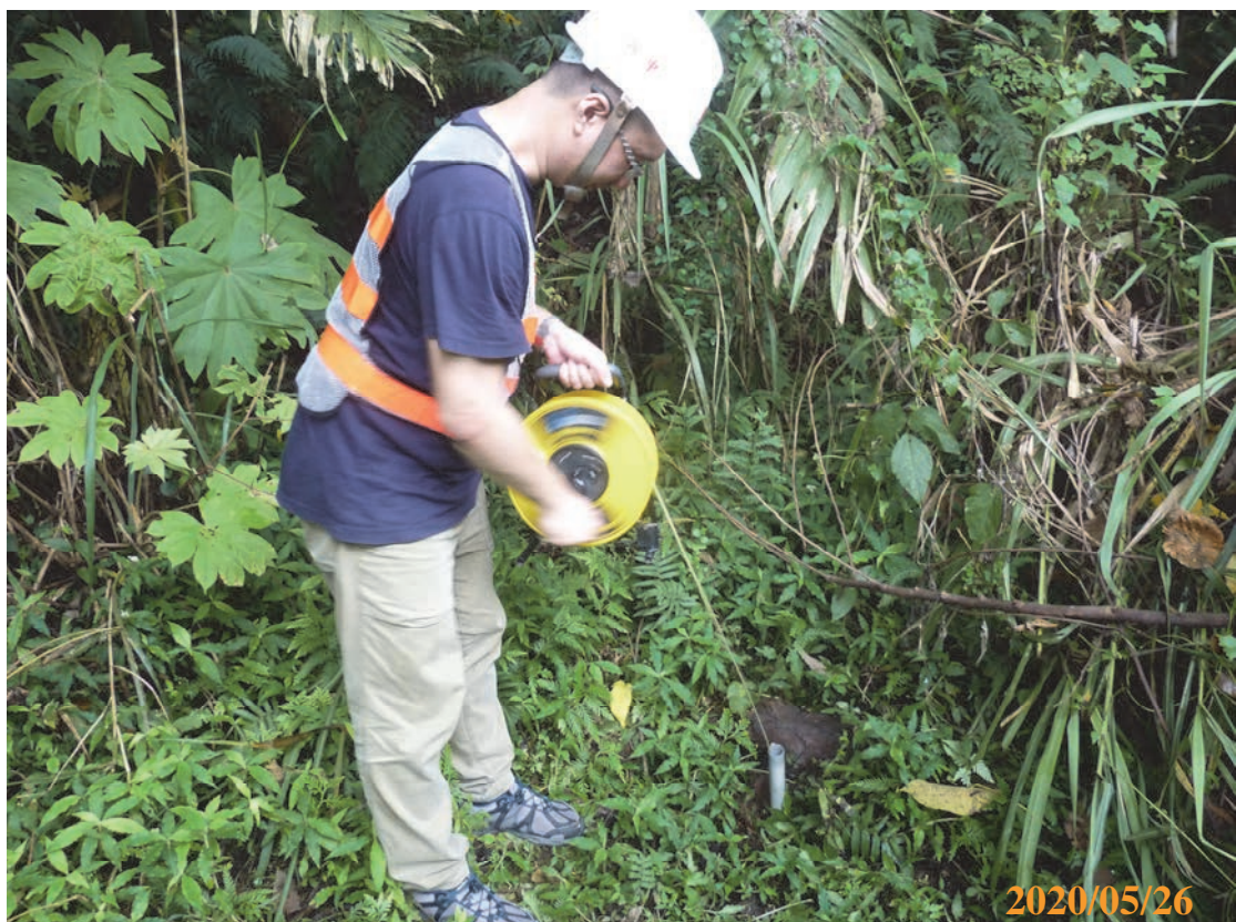
圖 1 計畫區既有地下水位井 PD-04 水位量測作業
