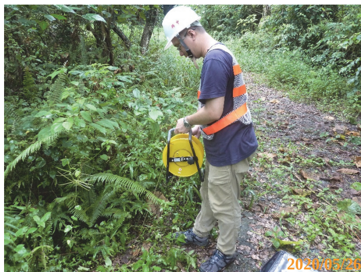
圖 3.5-3 PB-07 地下水位井現場量測作業情形
