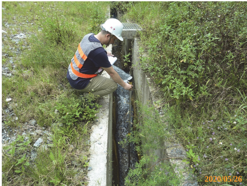
圖 3.1-1 觀音隧道北口洞口排水量以人工方式量測情形
