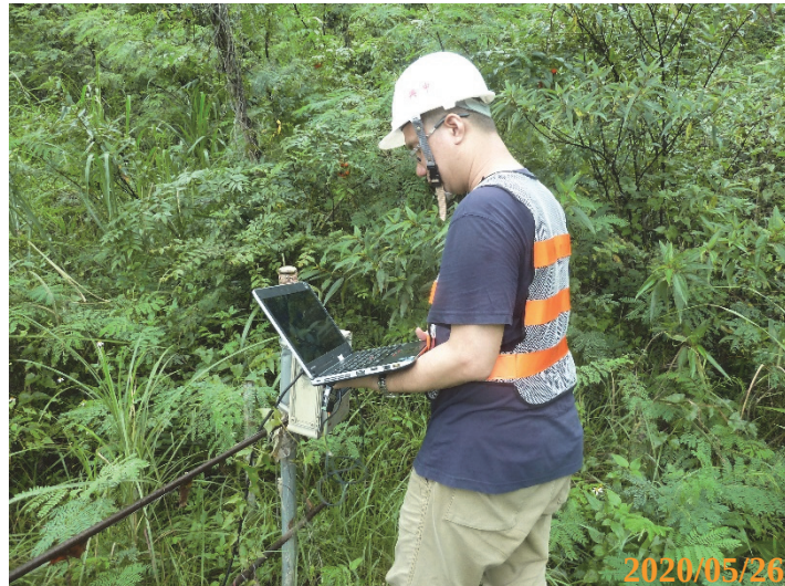
圖 3.5-1 BH-08 自記式水位觀測井資料下載作業情形
