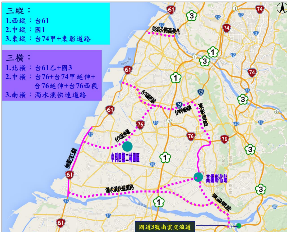
圖 3.1-6 彰化縣快速路網架構示意圖(原規劃發展構想)
