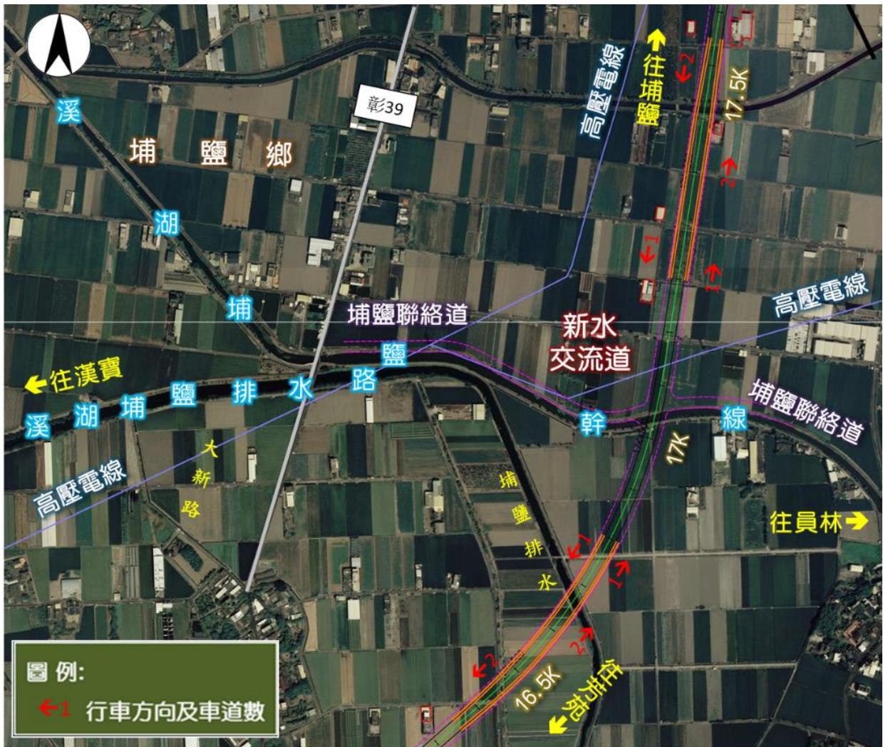
圖 2.2-9 新水交流道平面配置示意圖
