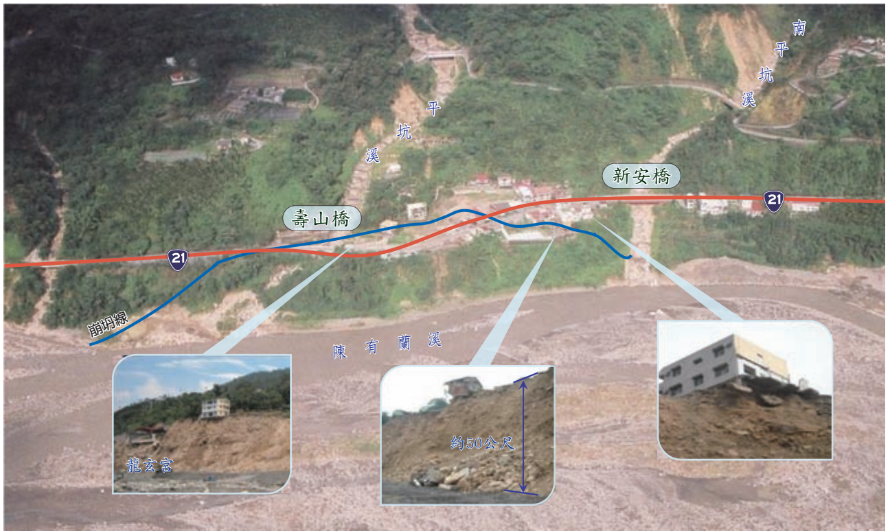
台21線79-80K新山路段以路堤回填方式復示意图
