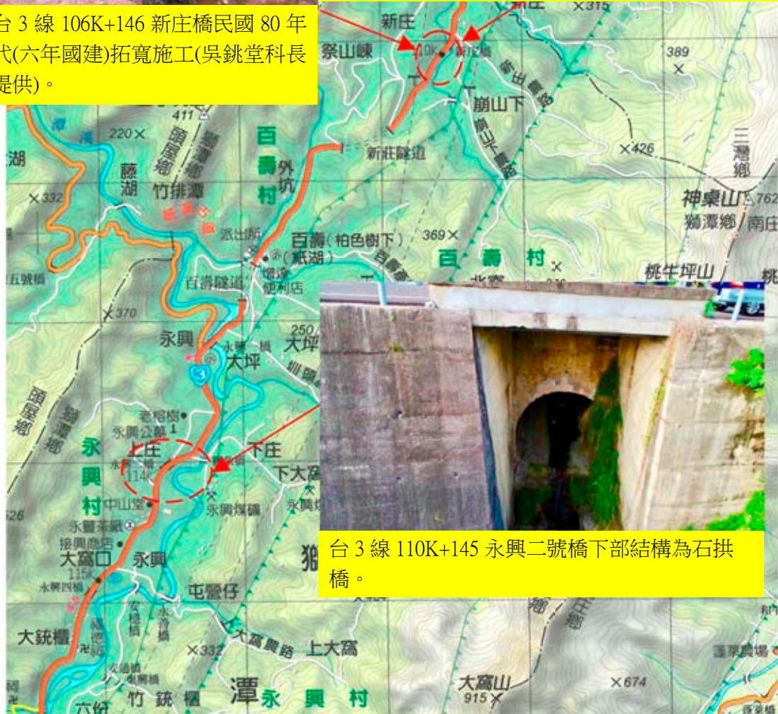
圖 4-1 台 3 線新庄橋及永興二號橋為與石造拱橋結構。
