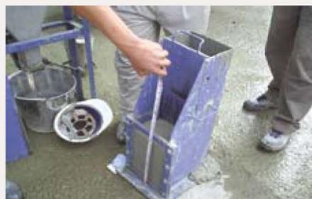
▲ 間隙通過試驗：U型填充高度試驗
