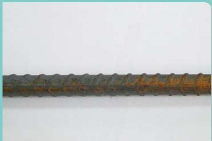
鋼筋表面已出現鐵斑，鈍態保護膜已破壞且影響斷面積及竹節尺度，不適用。
