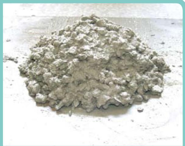
新拌混凝土中粗粒料用量過少，可能會影響混凝土硬固後性質，如乾縮、潛變等。
