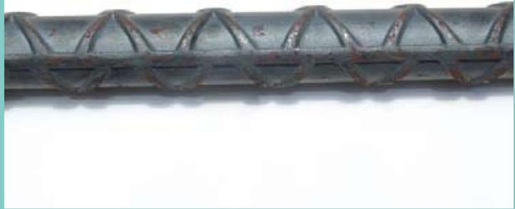
鋼筋表面略有生銹，尚未破壞鈍態保護膜及尺度，將表面生銹稍加清除，仍可使用。
