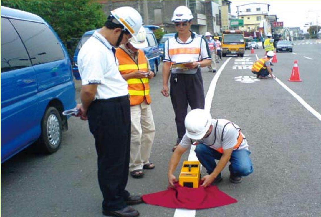
圖3-1-1 吳副總工程司進興（現任總工程司）領隊進行反光強度檢驗
