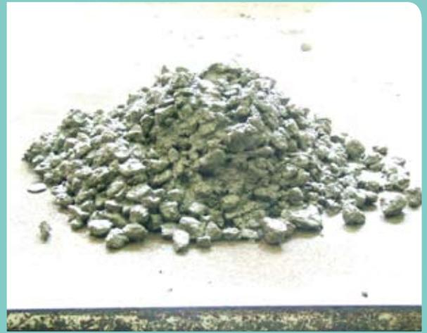
新拌混凝土中適當粗粒料用量，有助於混凝土搗實作業。
