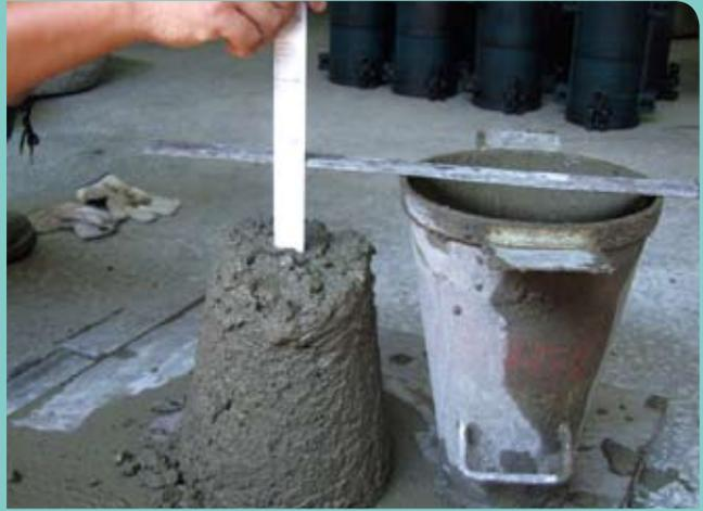
右圖坍度13cm為一般混凝土澆置作業常用坍度。圖示坍度儀尺寸可供粗略判斷坍度值之用。
