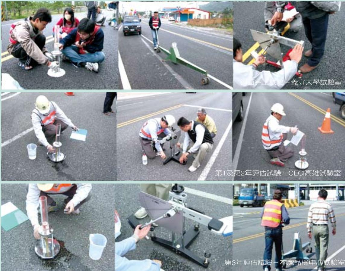
圖4-2-10 鋪面現地透水、平坦度及抗滑評估期間現地試驗（林進芳及品檢中心拍攝）
