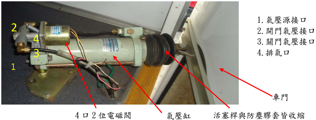
圖 3.1-5 氣動門開啟後，氣壓缸總成各零件位置
