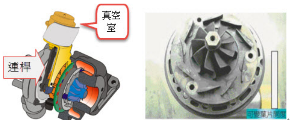
圖 1.2-6 可變幾何渦輪進氣增壓器構造圖 [2]
