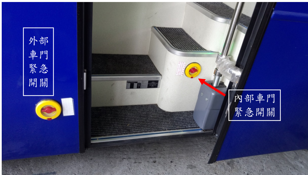
圖 4.4-4 車廂內部及外部的車門緊急控制開關
