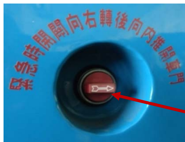
圖 3.1-8 車廂外的緊急開關處於開啟位置
