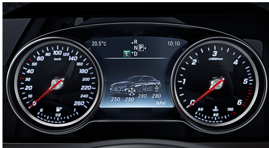
圖 3.3-9 整合型胎壓偵測警示系統[8]
