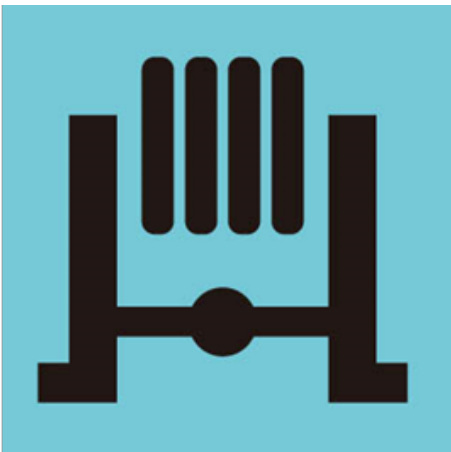
圖 3.3-1 排氣煞車操作指示燈[1]
