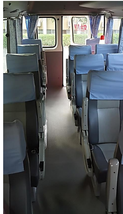
圖 4.3-3 乙類大客車安全門通道
