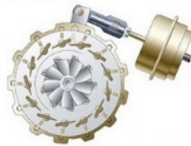
圖 1.2-9 低速時導流葉片開度小〔2〕
