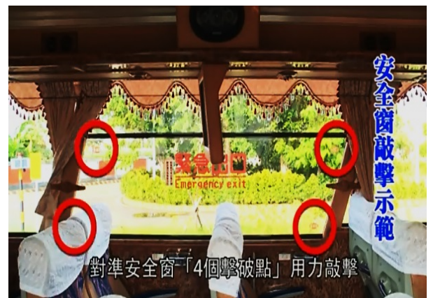
圖 4.3-7 玻璃式安全窗擊破點位置[3]
