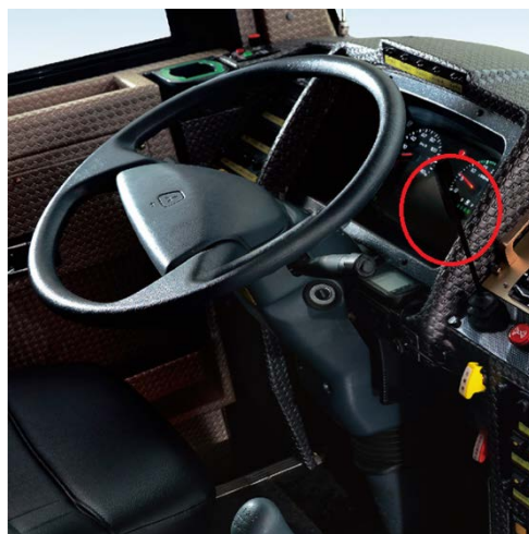
圖 3.3-6 電磁煞車操作桿位置[2]
