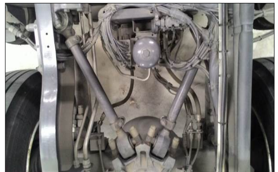
圖 3.1-45 前空氣懸吊系統與車架之配置[1] 圖 3.1-46 後空氣懸吊系統與車架之配置[1]
