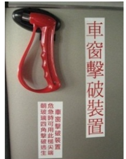
圖 4.3-6 車窗擊破裝置之標識和操作方法
