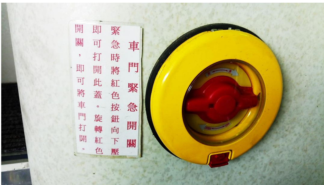
圖 4.4-5 清楚標示緊急控制開關操作方式
