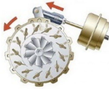
圖 1.2-8 高速時導流葉片開度大〔2〕
