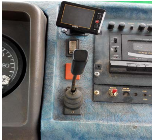
圖 3.3-7 電磁煞車開關操作段位
