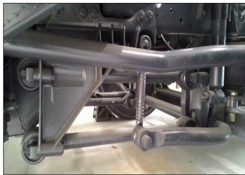
圖 3.1-45 前空氣懸吊系統與車架之配置[1] 圖 3.1-46 後空氣懸吊系統與車架之配置[1]
