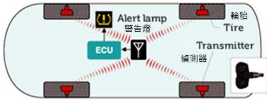
圖 3.3-3 直接式胎壓偵測系統[4]
