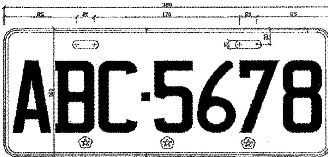
汽車號牌(長380mm*高160mm)，螺絲鎖孔位置圖
