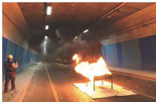
● 觀音隧道火盆試驗
