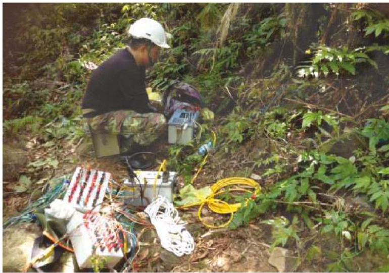
照0-85 地電阻影像施測：電探與資料集錄
