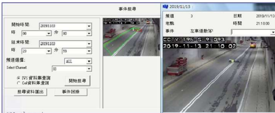
圖0-05 系統偵測到散落物並提出警告
