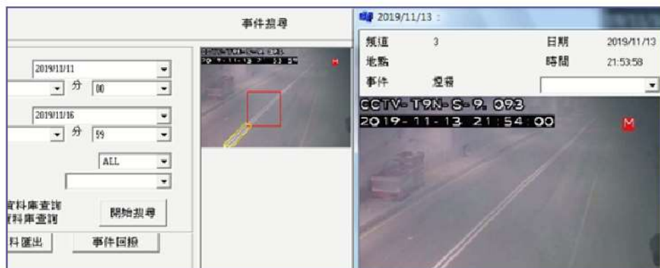
圖0-07 系統偵測能見度低於設定值並提出警告
