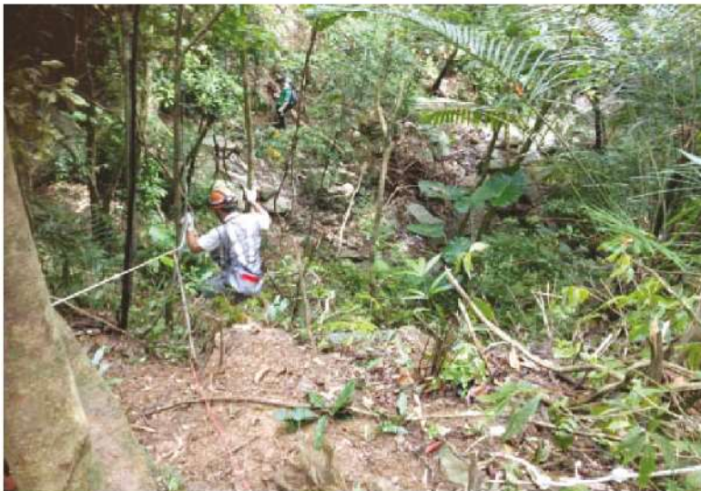
照0-86 地電阻影像施測：測線佈設
