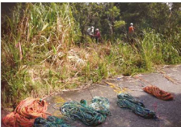
112照0-87 地電阻影像施測：測線佈設
