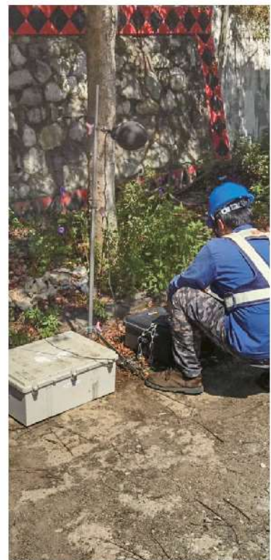
照0-05 噪音震動監測情形
