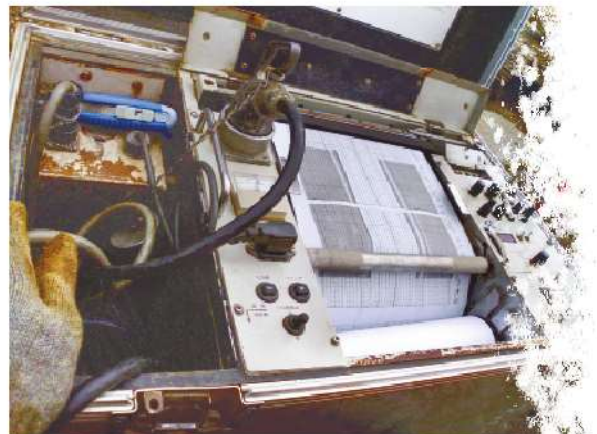
照0-13 全套管基樁步驟5：紀錄紙顯示孔徑、方向偏差值及深度
