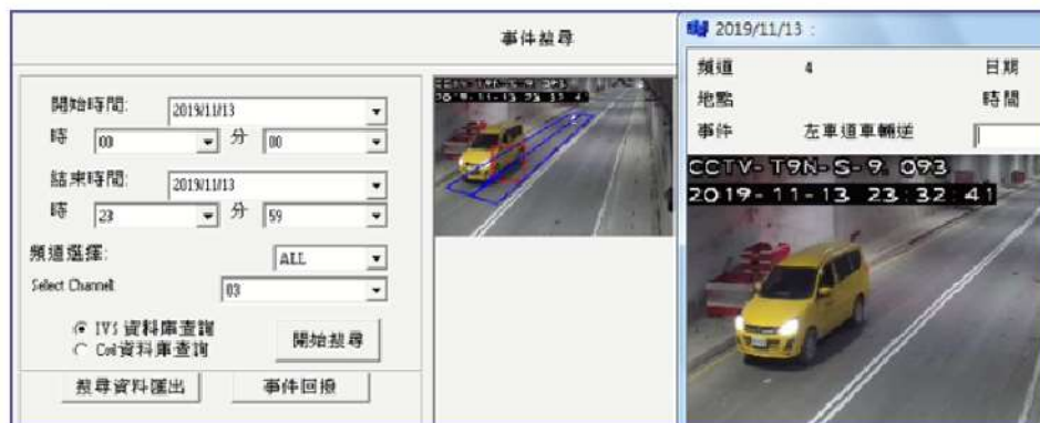
圖0-06 系統偵測到散落物並提出警告
