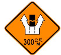
中間封閉 (前方 300 公尺處)
