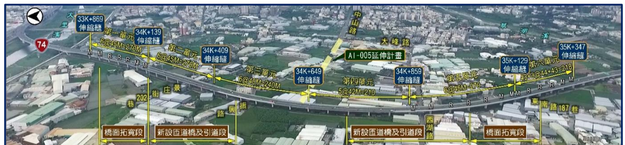
圖 5.5 台 74 線大里聯絡道橋梁跨度及支承型式配置示意圖
