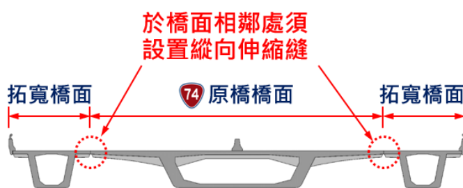
圖 8.1 縱向伸縮縫配置示意圖
