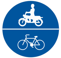
道路專行車輛 (道路指定自行車及 大型重型機車以外之 機車專行)
