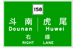
高(快)速公路出口 預告(二)
