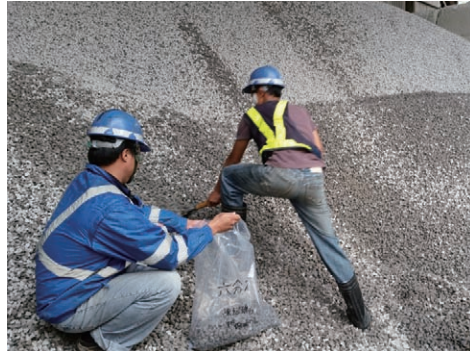
105年04月13日龍形預拌廠混凝土材料取樣
