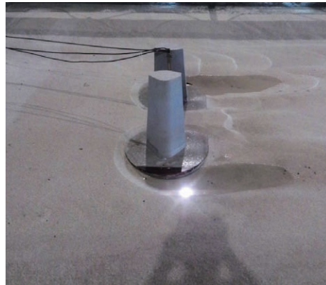
修正之主塔基礎沖刷試驗後墩基周邊侵淤情形
