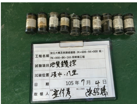
105年07月04日鑽探旁管取樣試體送驗
