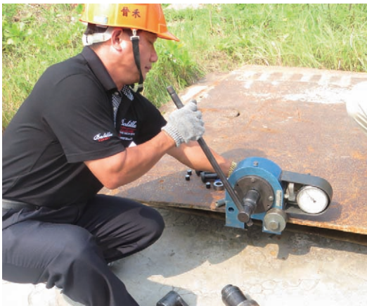
高拉力螺栓軸力及扭力測試
