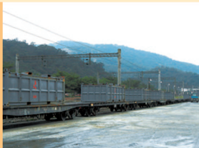
永樂車站採「石頭坐火車」方式出碴
