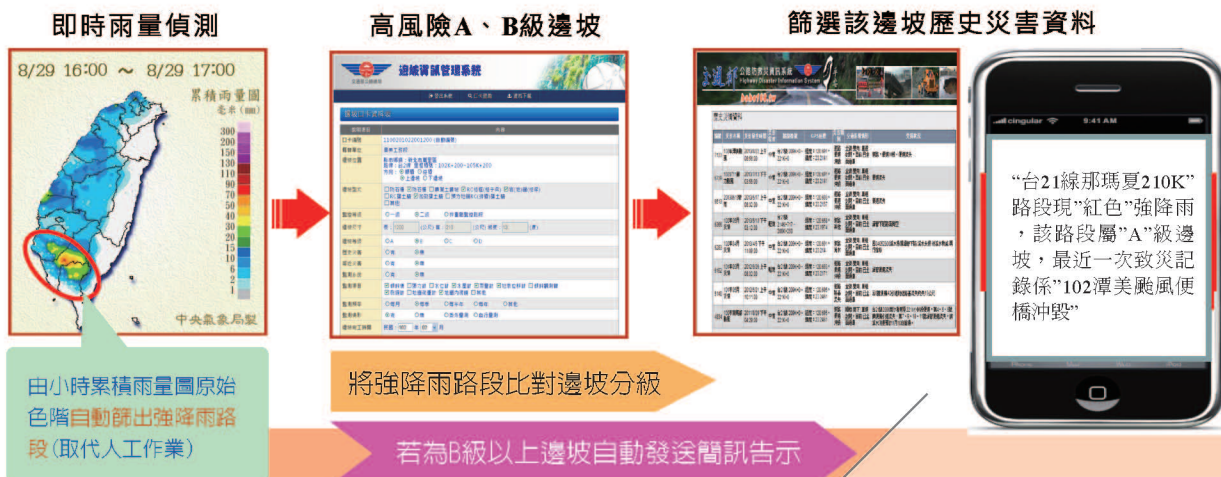
圖5 全時高風險路段自動預警系統
