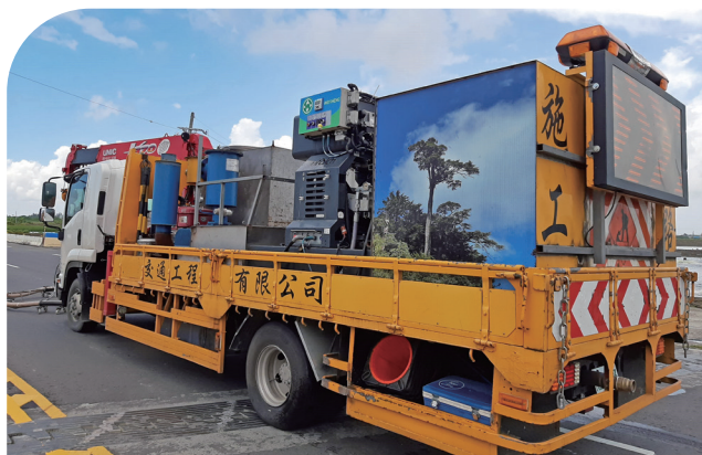
水刀水箱真空裝置集塵箱整合在同 1 機裡
