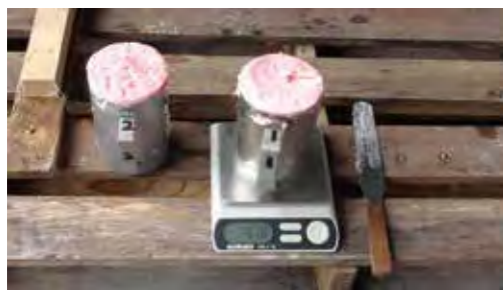
現場拌合乳膠爆劑比重試驗
