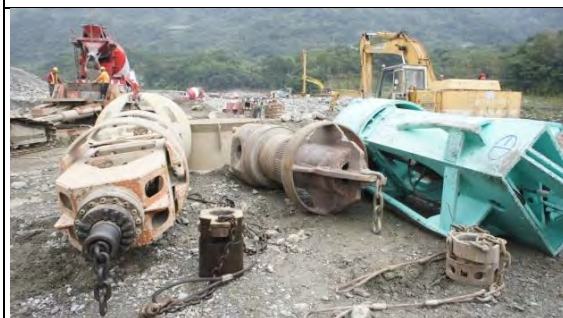
➤ A3 標工區實景：基樁工程用鑽頭
