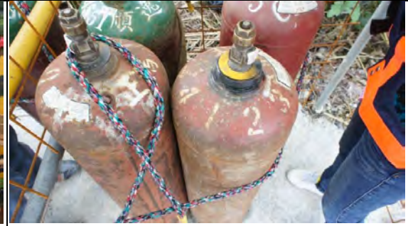
➤ A3 標工區實景：工料登錄編號「MA-頤達 01&」氧氣瓶與乙炔瓶
