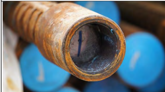
➤ A3 標工區：鋼筋續接器(母)
