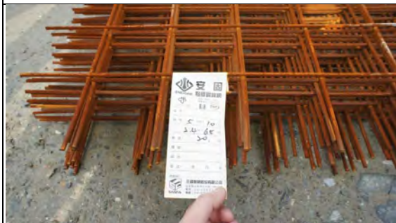
➤ A3 標工區實景：工料登錄編號「MA-弘大鑫 03」點焊網(含規格標籤)
