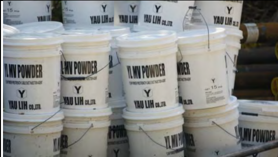
➤ A2 標工區(南口)：邊坡預力地錨灌漿材料，MA 堯堂-01 無收縮摻料
