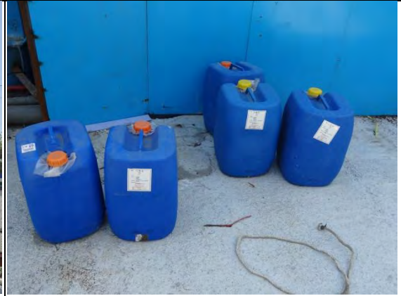
➤ C1 標南口：污水處理設備使用藥劑-硫酸鋁
