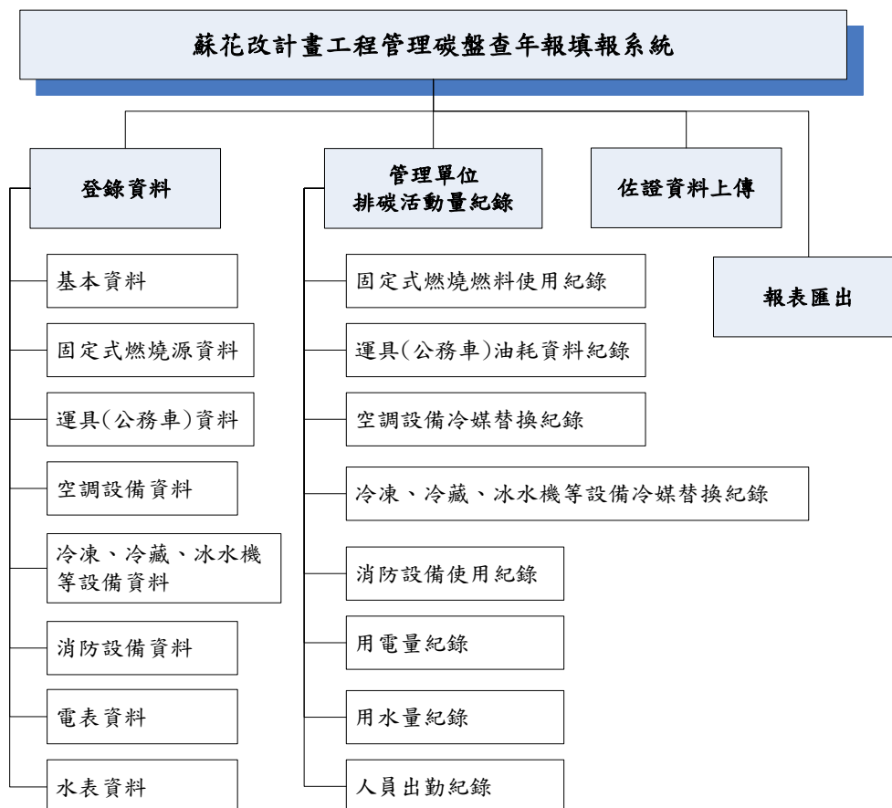
圖 3.2.6-1 蘇花改碳排盤查年報填報系統架構
