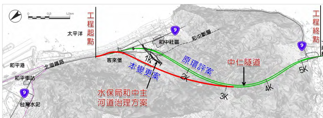
圖 3.4.2-2 中仁隧道新建工程(C1 標)工程範圍變更案路線方案示意圖
