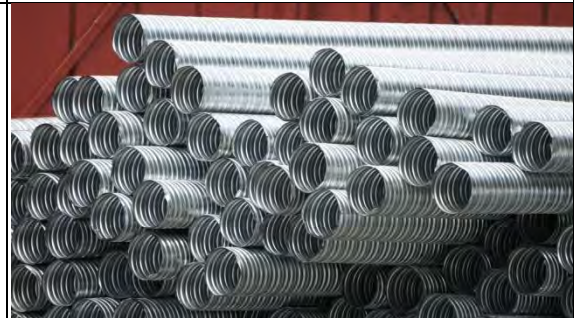
➤ A3 標工區：MA-樂志 05 預力套管
