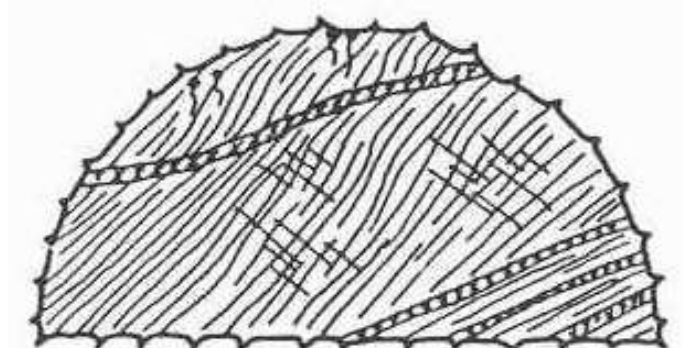
圖 2.1-15 硬頁岩夾板岩－岩盤常夾有小剪裂帶，局部有滲水情形
