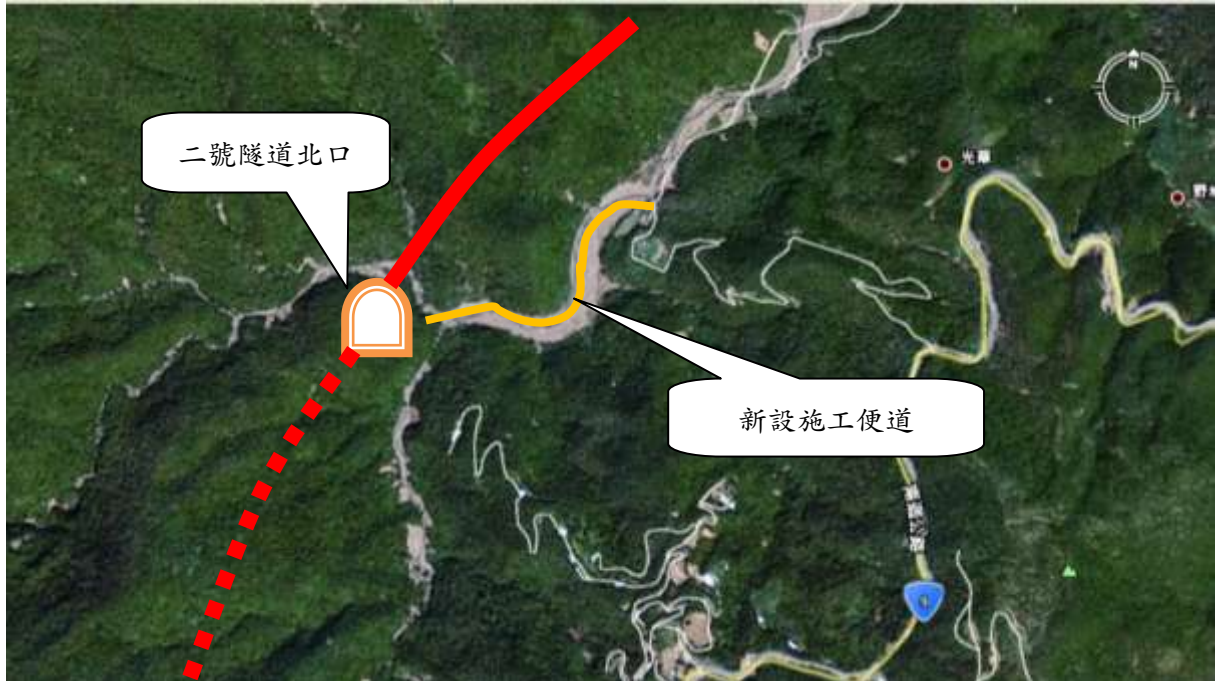
圖 8.5-1 二號隧道北口施工便道平面圖
