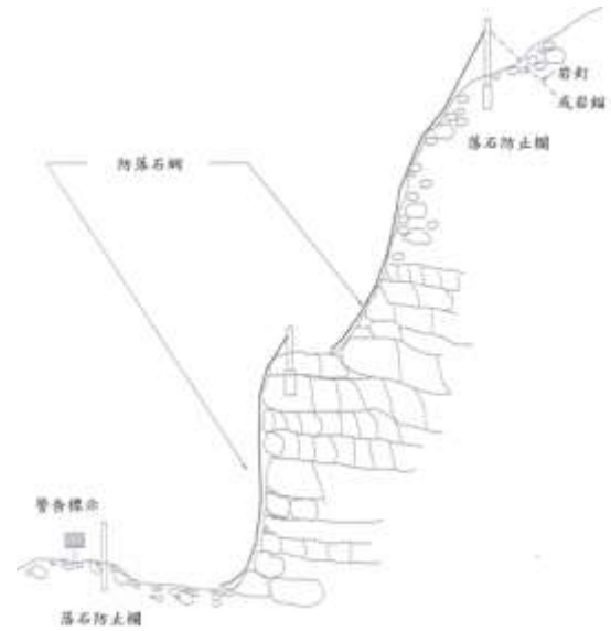
圖 4.6-12 防落石網及凸石溝護坡方式
