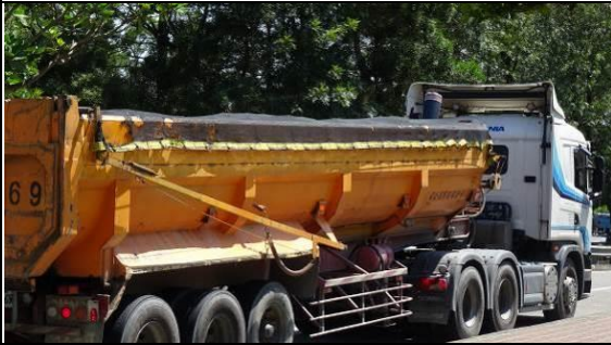
砂石車車斗覆蓋防塵布
