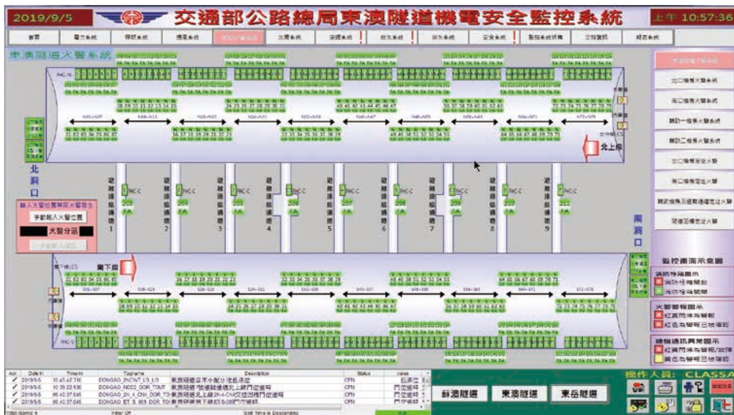
蘇花改東澳隧道機電監控系統
