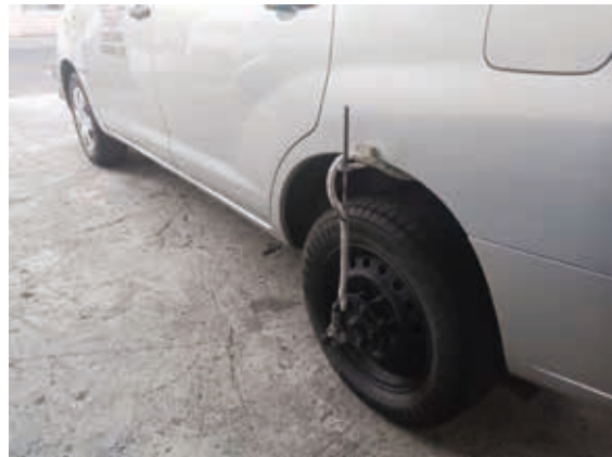
檢測車後輪感應設施
