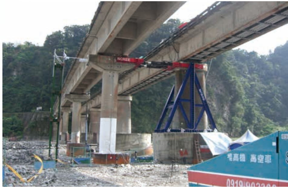
舊牛鬥橋模擬地震力(側向力)測試
