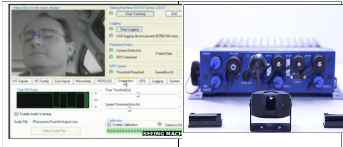
圖 2-15 疲勞監測系統及紅外線攝影機
