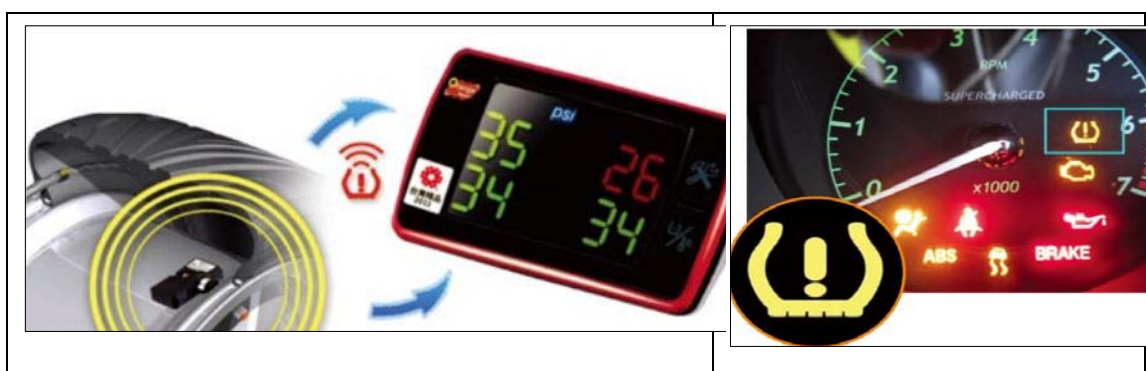
圖 2-12TPMS 壓力檢測模組與顯示器及警告訊號
